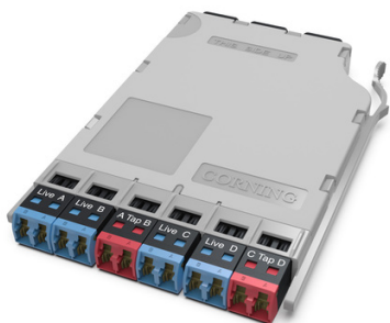
Módulo de Derivação EDGE80®, Monomodo (OS2), 50/50 razão de divisão (live/tap), dois adaptadores LC duplex vermelhos rotulados TAP, quatro adaptadores LC duplex azuis rotulados LIVE
